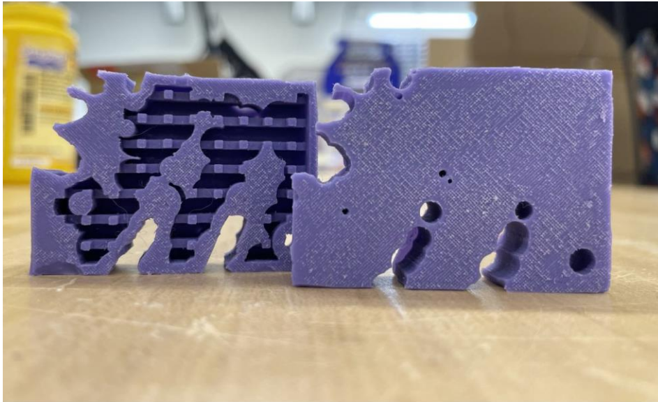
Abbildung 2: KI-designter Roboter zur Fortbewegung, die linke Seite zeigt die „air muscles“; Quelle: Northwestern University
